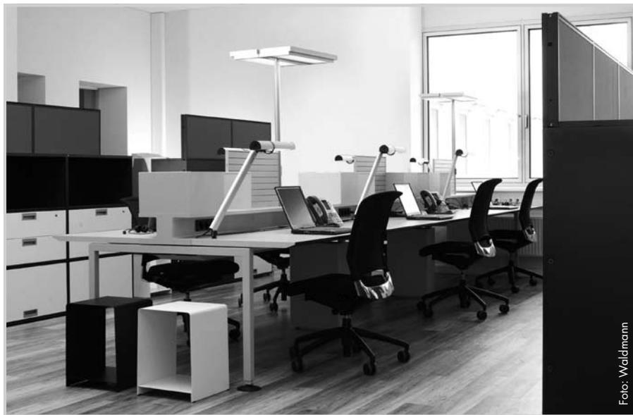
*Empfehlenswert an dem abgebildeten „Musterbüro“ sind die direkt/indirekt abstrahlenden Stehleuchten in Kombination mit Arbeitsplatzleuchten; sie bieten hohen Komfort durch individualisierbare Beleuchtungsstärken (nicht zu empfehlen sind allerdings die tragbaren Rechner am Bildschirmarbeitsplatz und auch die verdichtete „Sitzordnung“ an dem Bürotisch ist nur für kurzzeitige Projektarbeit empfehlenswert).*
